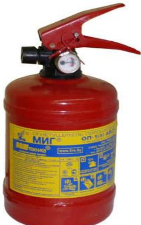
Порошковые огнетушители заряжены огнетушащим порошком и закачаны газом (воздух, азот, углекислый газ) до давления 16 атм.
